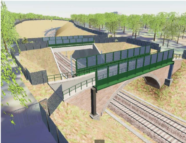
Construction d'un passage à faune doublant le pont des Volières
